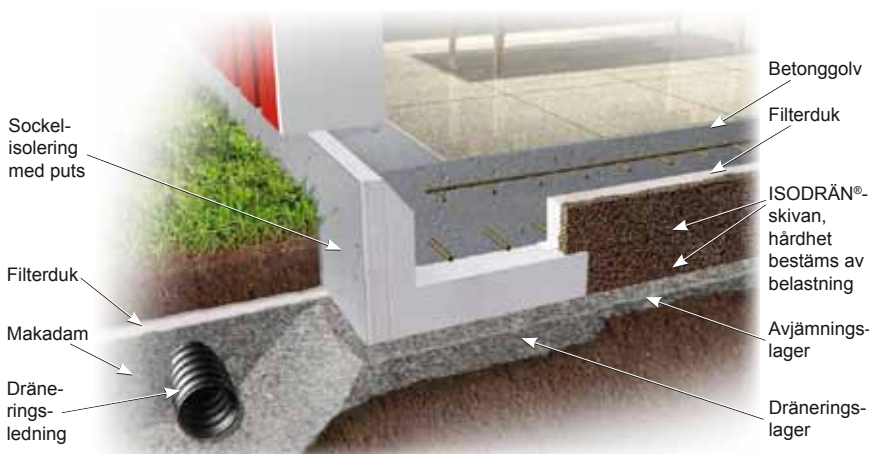
Varmt och fuktsäkert golv (nyproduktion)
